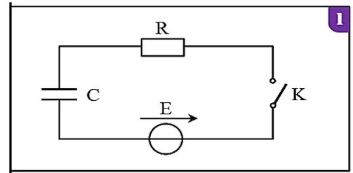
A  $t = 0$ , on ferme l'interrupteur  $K$  et on suit l'évolution de l'intensité de courant  $i(t)$  en fonction de temps dans le circuit. On obtient la courbe de la figure (2).
